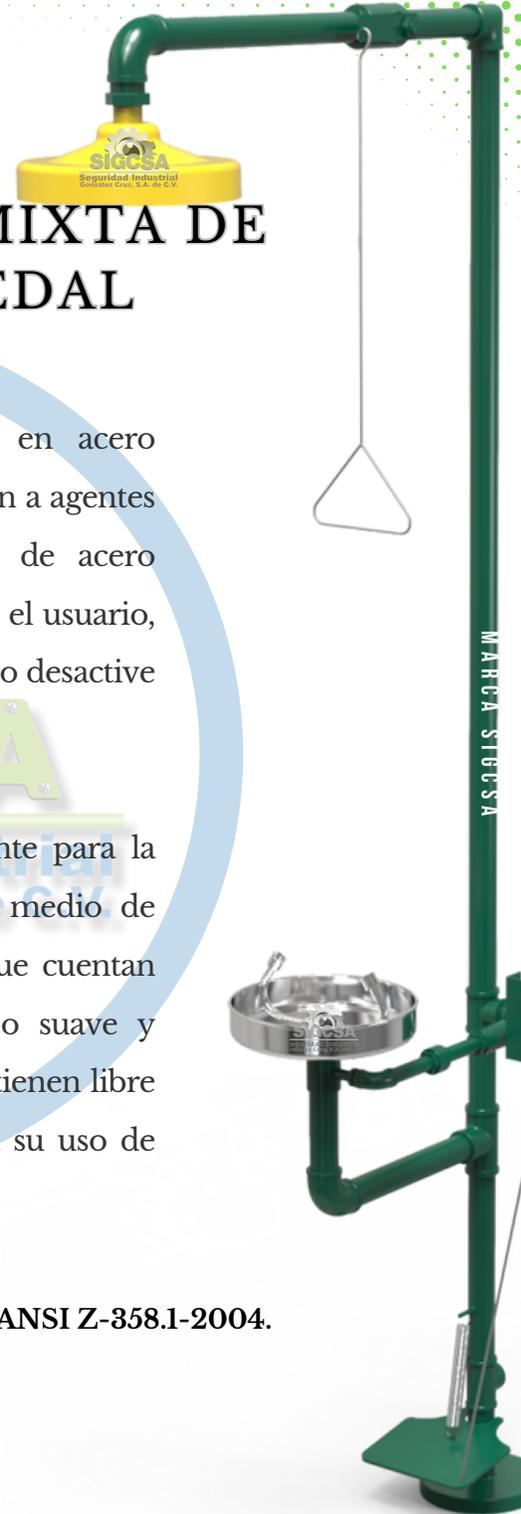
El modelo GC-113-CP es una regadera mixta fabricada en acero galvanizado cédula 40, ideal para ambientes con baja exposición a agentes corrosivos. La regadera es activada mediante un gancho de acero inoxidable de 60 cm de largo, la cual no se desactiva hasta que el usuario, una vez cumplido el tiempo establecido de descontaminación, lo desactive de manera manual.
